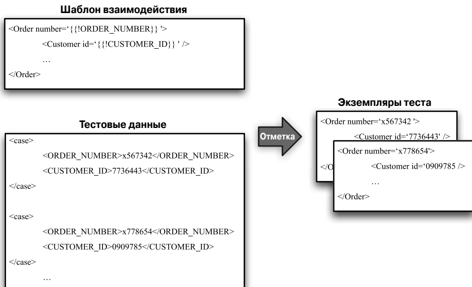
Рис. 9.6. Создание экземпляров тестов на основе шаблонов взаимодействий
