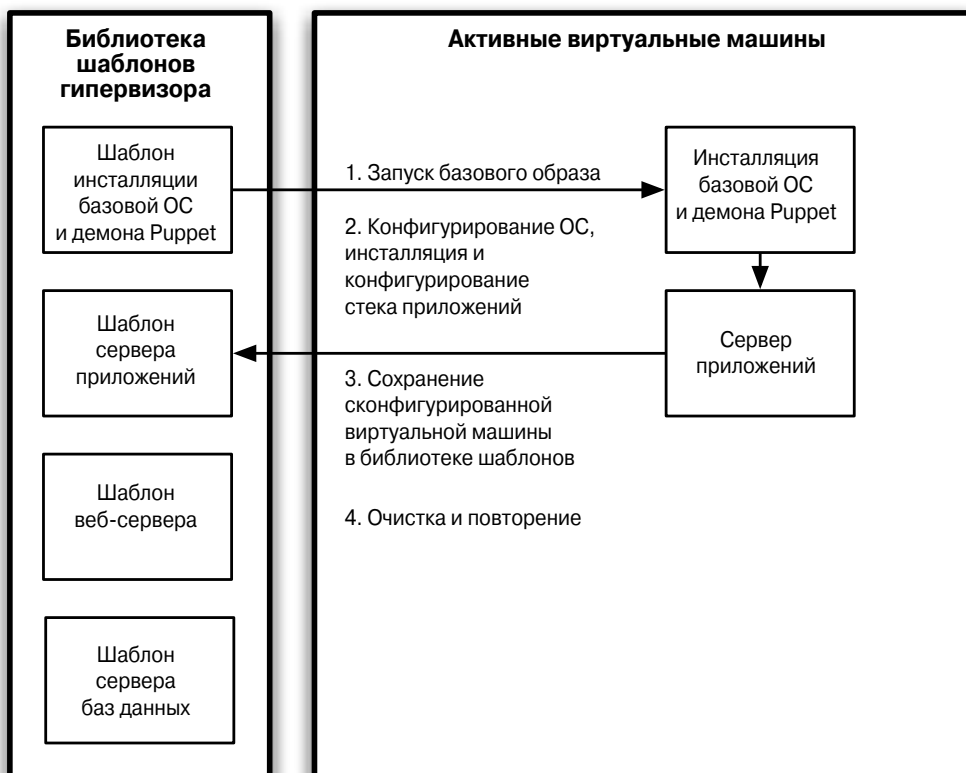
Рис. 11.5. Создание шаблонов виртуальных машин
